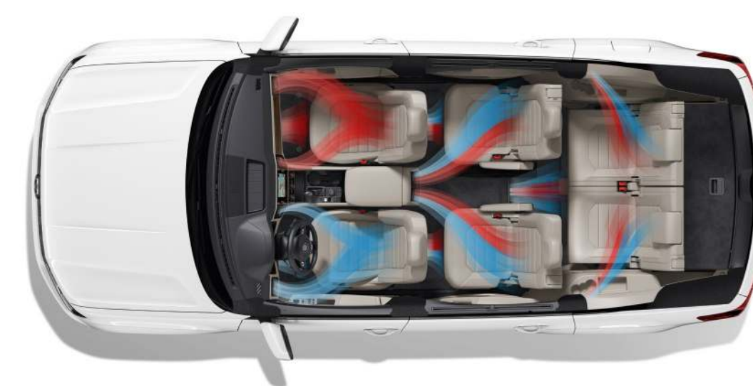
Трехзонный климат-контроль Climatronic с антиаллергенным фильтром O
