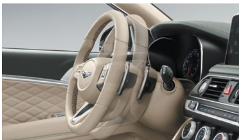
Рулевая колонка с электроприводом регулировок по высоте и вылету
