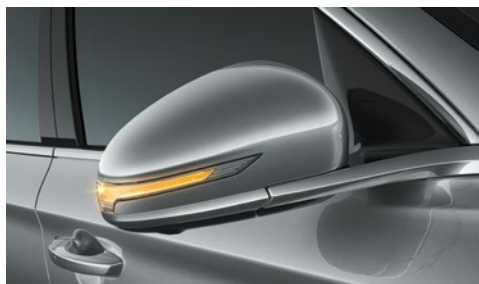
Боковые зеркала со встроенными светодиодными повторителями указателей поворота
