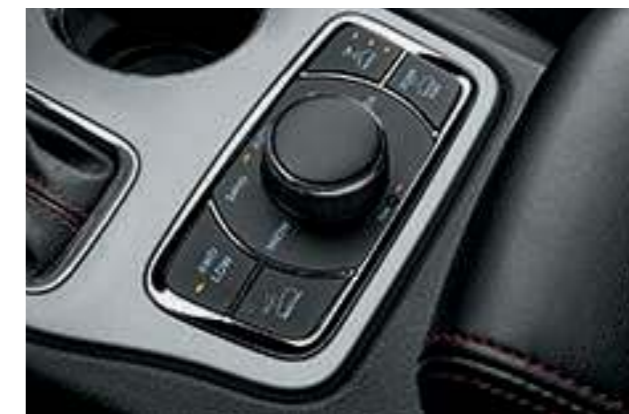
СЕЛЕКТОР SELEC-TERRAIN™ С СИСТЕМАМИ ПОМОЩИ ПРИ СПУСКЕ (HDS) И ПОМОЩИ ПРИ СТАРТЕ НА ПОДЪЕМЕ (HSA)
