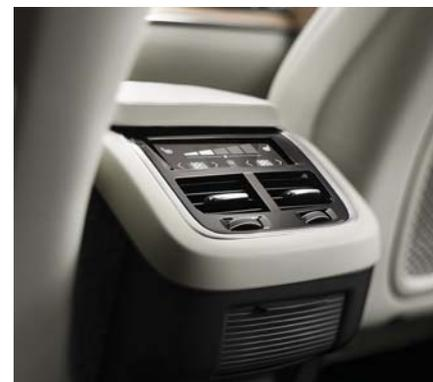
Четырехзонной системой климат-контроля можно управлять с центрального сенсорного дисплея или с изящной сенсорной панели управления в задней части консоли тоннеля.
