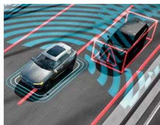
**Система мониторинга «слепых» зон с подруливанием (BLIS™)**
