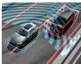
**Система мониторинга «слепых» зон с подруливанием (BLIS™)**
