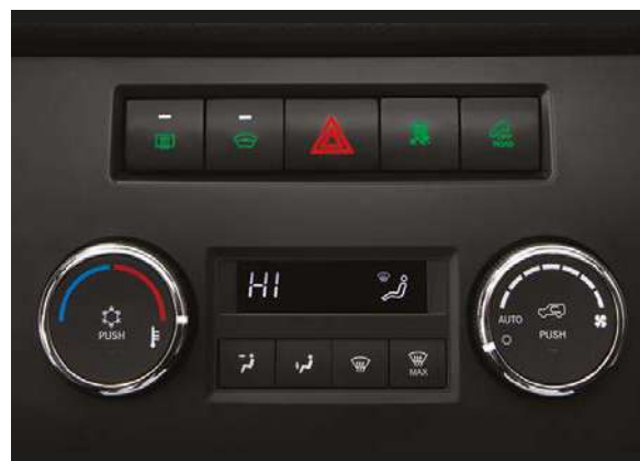
Полностью обновленная система отопления, вентиляции и кондиционирования с функцией климат-контроля
