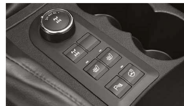
Блок управления системами на центральном тоннеле
