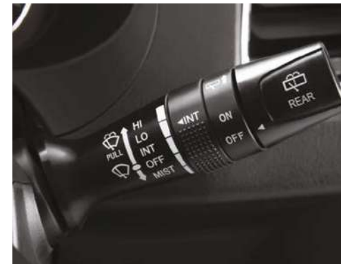
Правый подрулевой переключатель с регулировкой паузы стеклоочистителя
