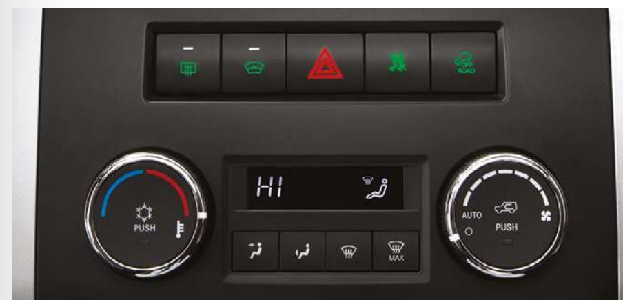
Полностью обновленная система отопления, вентиляции и кондиционирования с функцией климат-контроля
