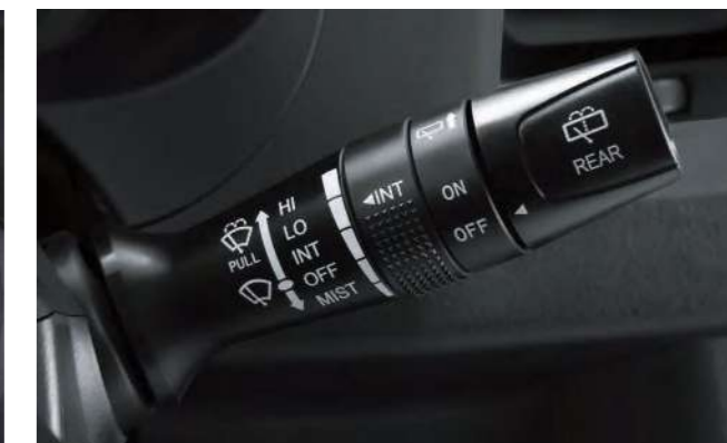
Правый подрулевой переключатель с регулировкой паузы стеклоочистителя
