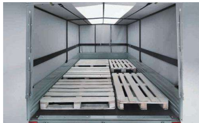
Светопроницаемая крыша. Прочный проклеенный тент
