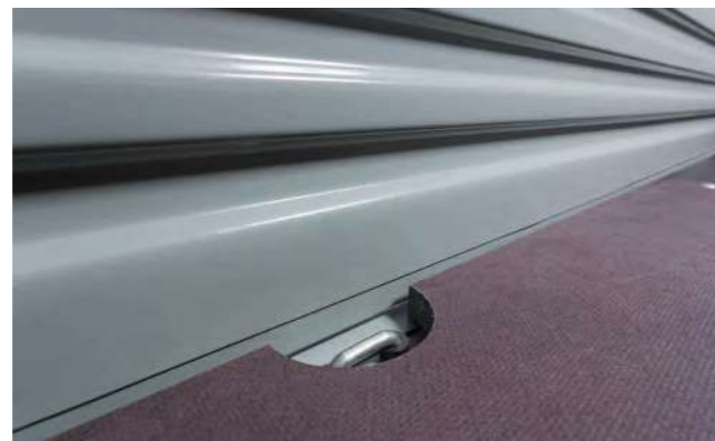
Крепление груза с помощью скрытых такелажных петель
