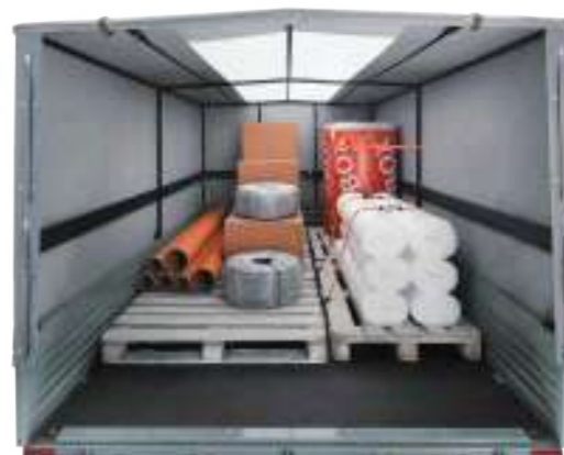
Световое окно тента позволяет видеть груз без дополнительной подсветки
