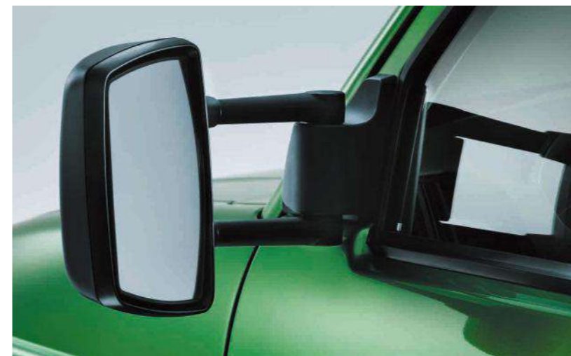
Зеркала с подогревом и электрорегулировкой (для стандартной платформы)
