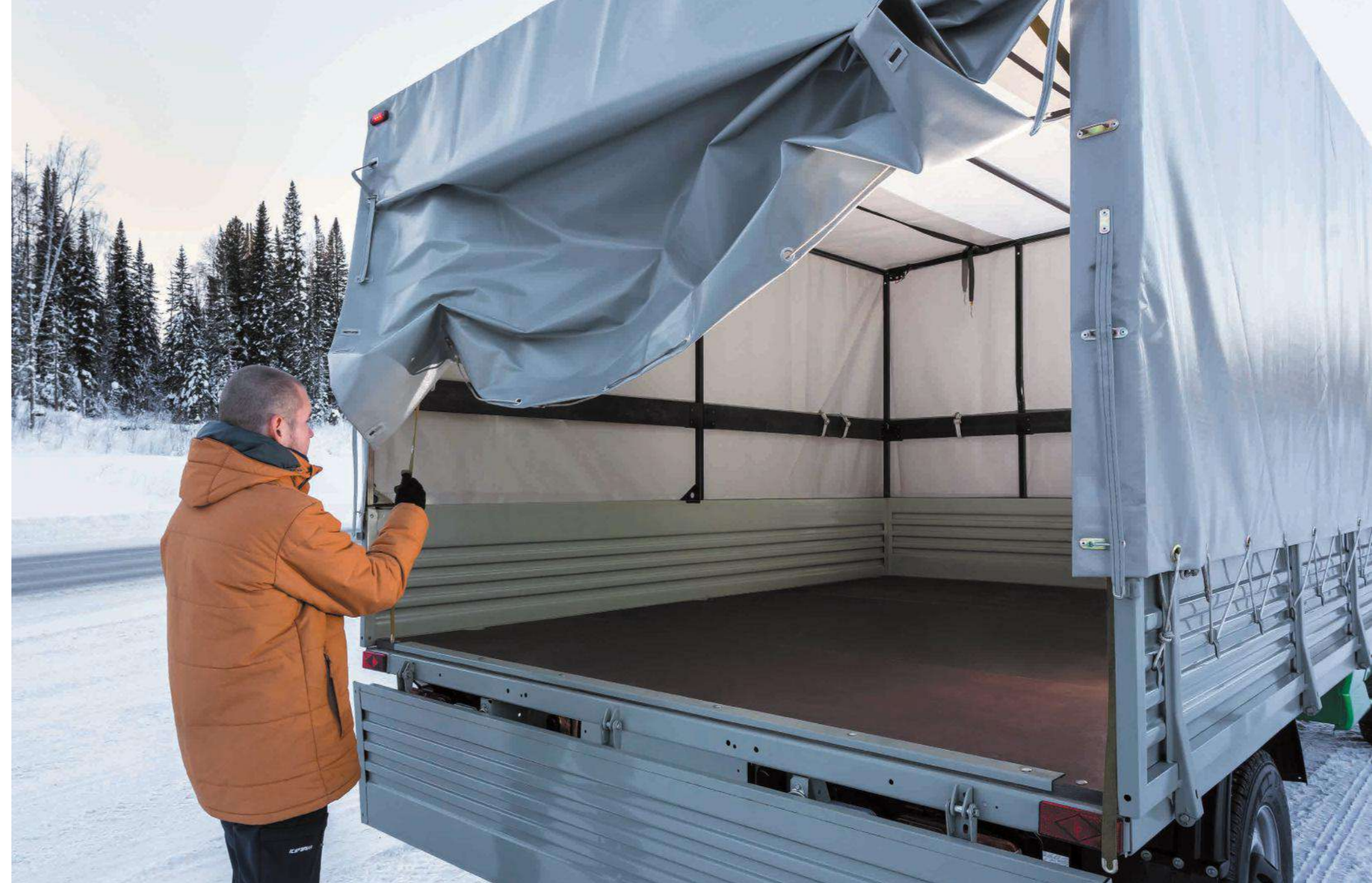
Потянув за ремни, Вы можете поднять клапан тента без использования подручных средств и зафиксировать его в открытом положении с помощью крючков
