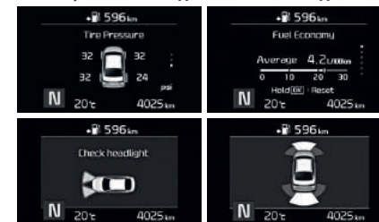
Монохромный ЖК-дисплей TFT 3,5 дюйма
