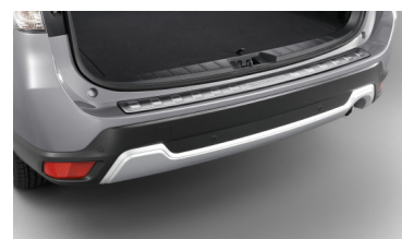
Стальная накладка на порог багажника
